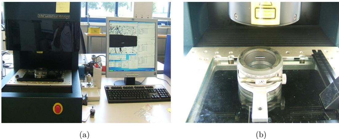
Figure 2.7: Mesure du profil d'un boulet : (a) vue d'ensemble du projecteur et du PC qui affiche le profil, (b) détail du boulet sur son support.
