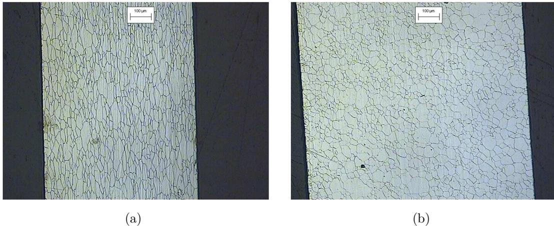
Figure 1.14: Métallographie avec grossissement x100 (a) avant recuit (b) après recuit
